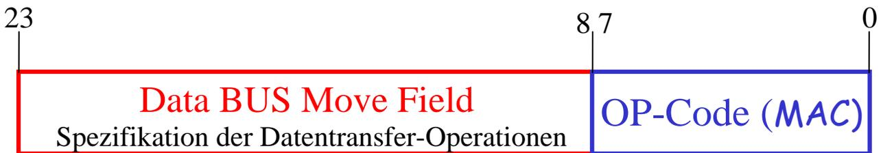
Bild 4.125: Aufbau einer typischen DSP-Instruktion
