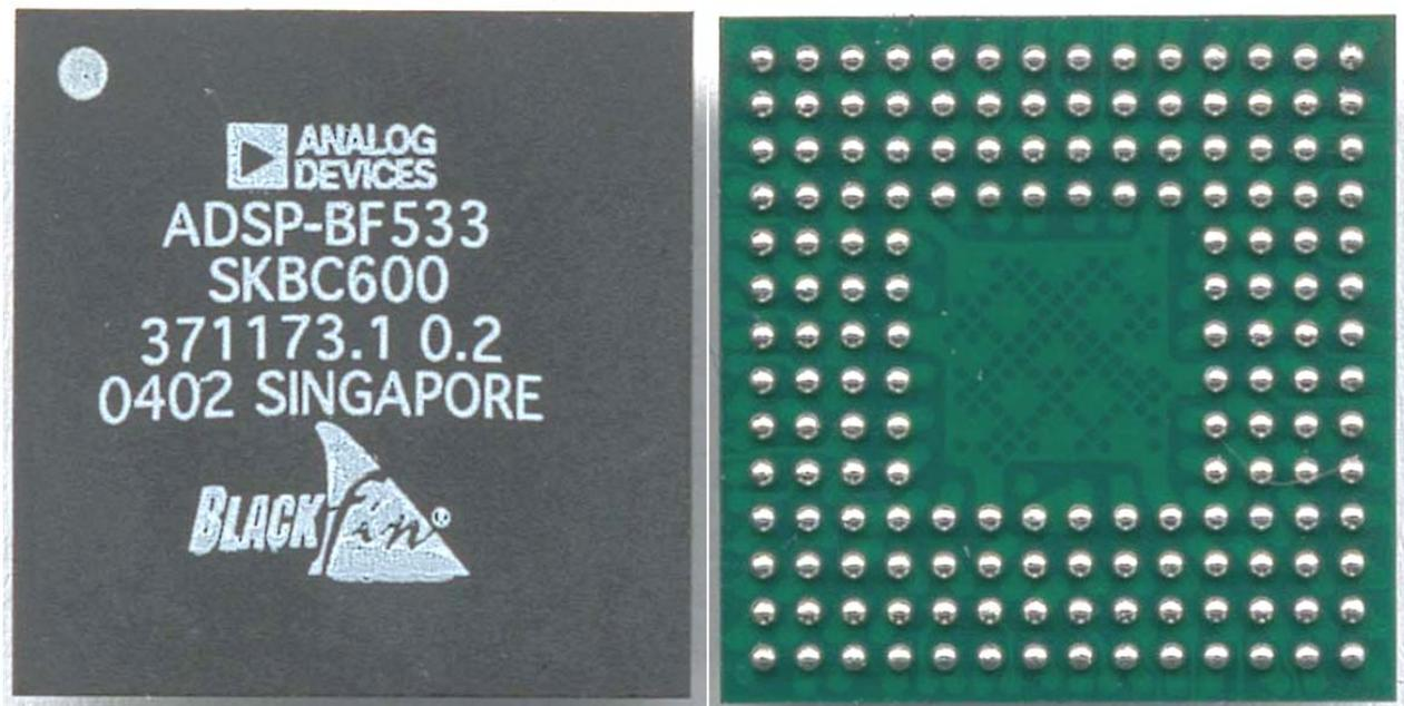
Bild 1.5: Blackfin-Prozessor im „Ball Grid Array“ (BGA) Gehäuse
